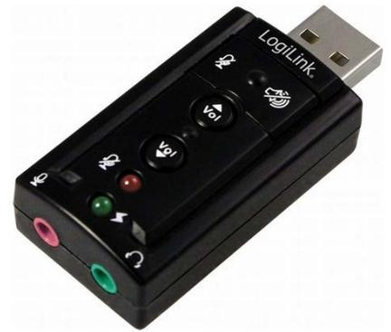
Der Mikrofonempfänger wird mit dem beiliegenden Audiokabel mit dem USB-Audio-Adapter (rote Anschlussbuchse/Mikrofon) verbunden. Sollten getrennte Buchsen an dem verwendeten Laptop vorhanden sein, können diese auch direkt genutzt werden.
